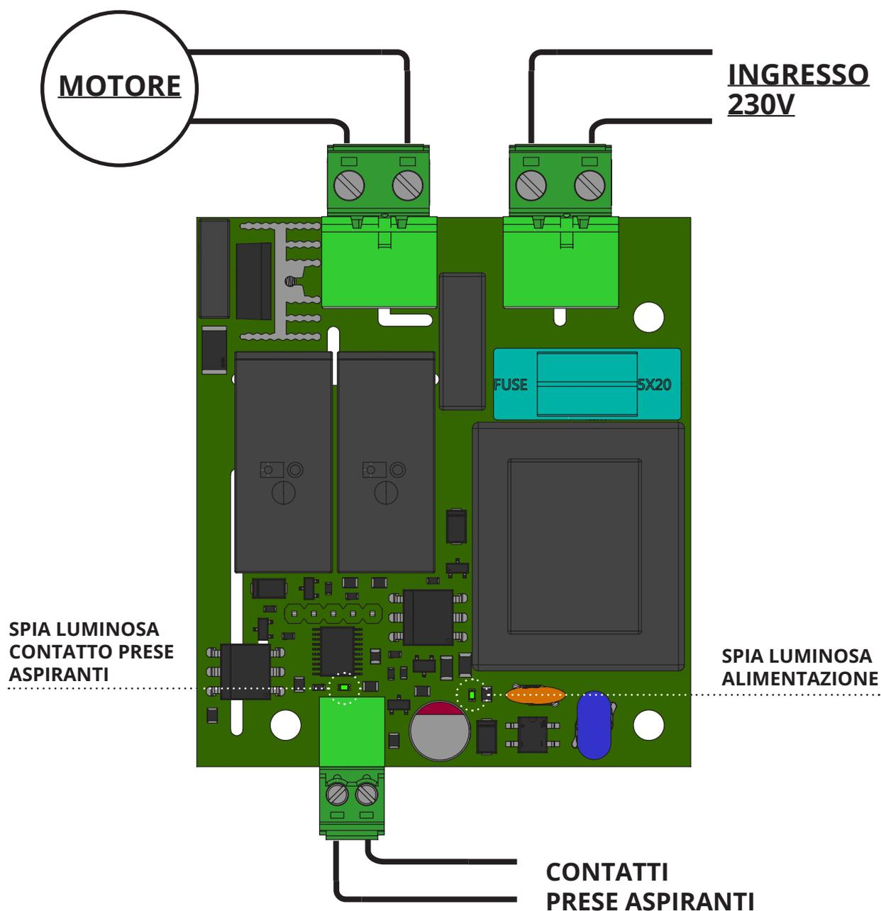
La spia luminosa di alimentazione resta sempre accesa per segnalare che la scheda elettronica è collegata correttamente all'alimentazione 230V. Se la spia non si accende verificare il collegamento alla 230V e il fusibile.
